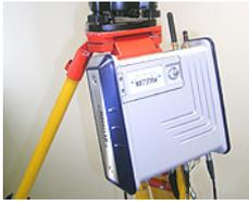
In Vermessungsanwendungen kann der ProFlex 500 als transportable Basis an einem Stativbein befestigt werden. Dazu verfügt er über eine Lasche an der Geräteunterseite. Diese Befestigungsart wird unter *Vorübergehendes Aufbauen einer RTK-Basis auf Seite 22* beschrieben.
