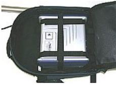
Der ProFlex 500 wird als Rover in Vermessungsanwendungen sicher in einem Rucksack untergebracht. Die Befestigung des Empfängers im Rucksackpaket wird unter *Aufbauen eines RTK-Rovers auf Seite 26* genau beschrieben.
